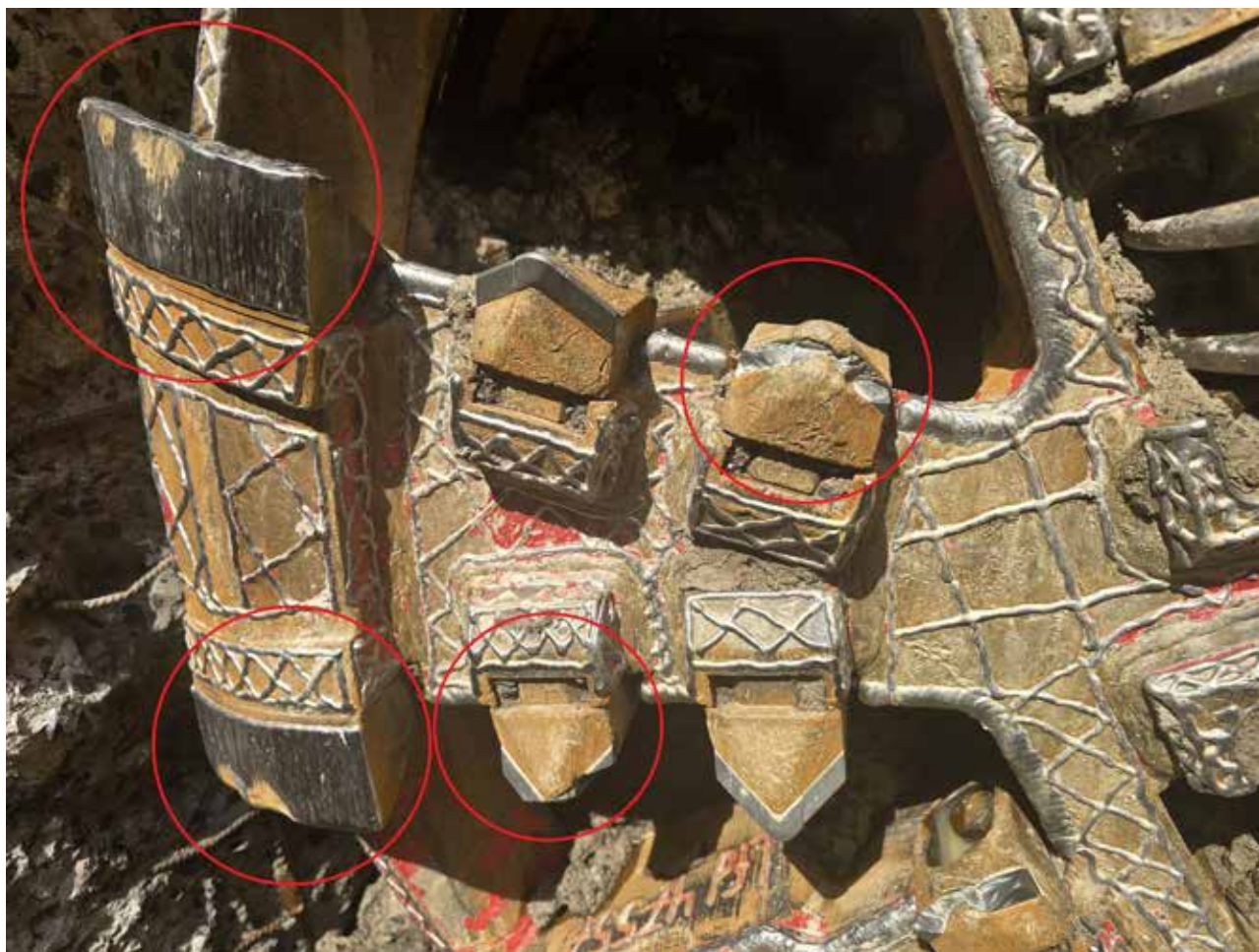
Obr. 9 – Zničené řezné nástroje po projetí křemenci
