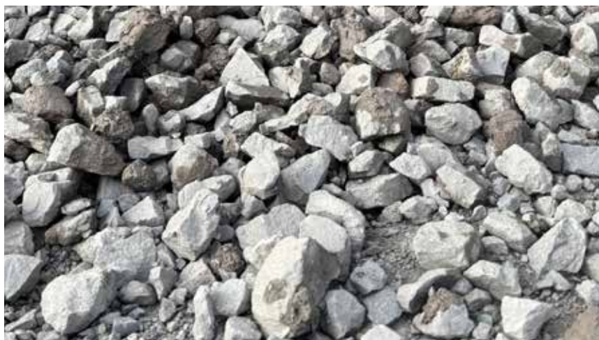
Obr. 2 – Vytěžený plastický jíl a předrcený křemenec drtičem stroje na konci separačního zařízení HKS150
