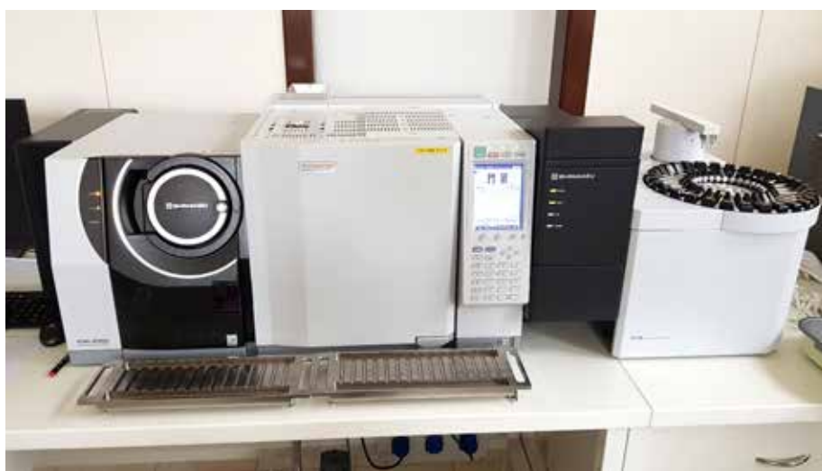
Obr. 3 Plynový chromatograf s hmotnostním spektrometrem Shimadzu GCMS-GP2020 v laboratoři ITC Zlín
