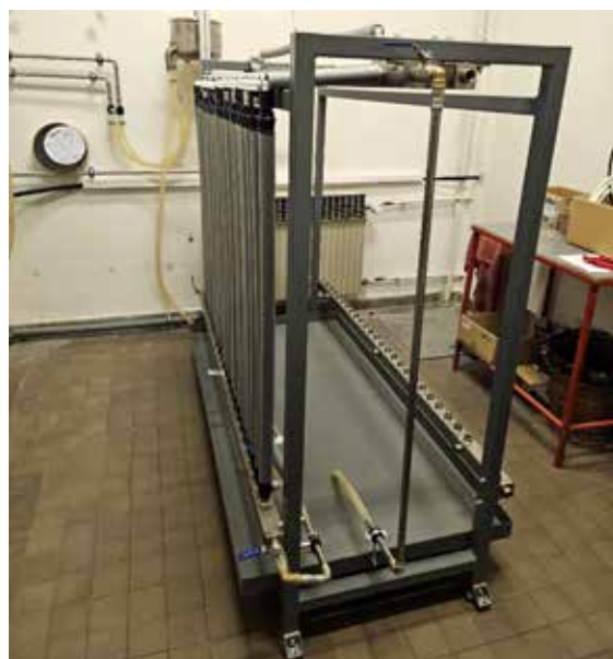
Obr. 2 Detail zkušebního zařízení pro zkoušky trubek na EMG
