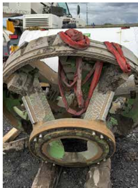
Obr. 5 – Přestavba stroje AVN1200 TC z DN 1400 na DN 1200 v podmínkách in-situ
