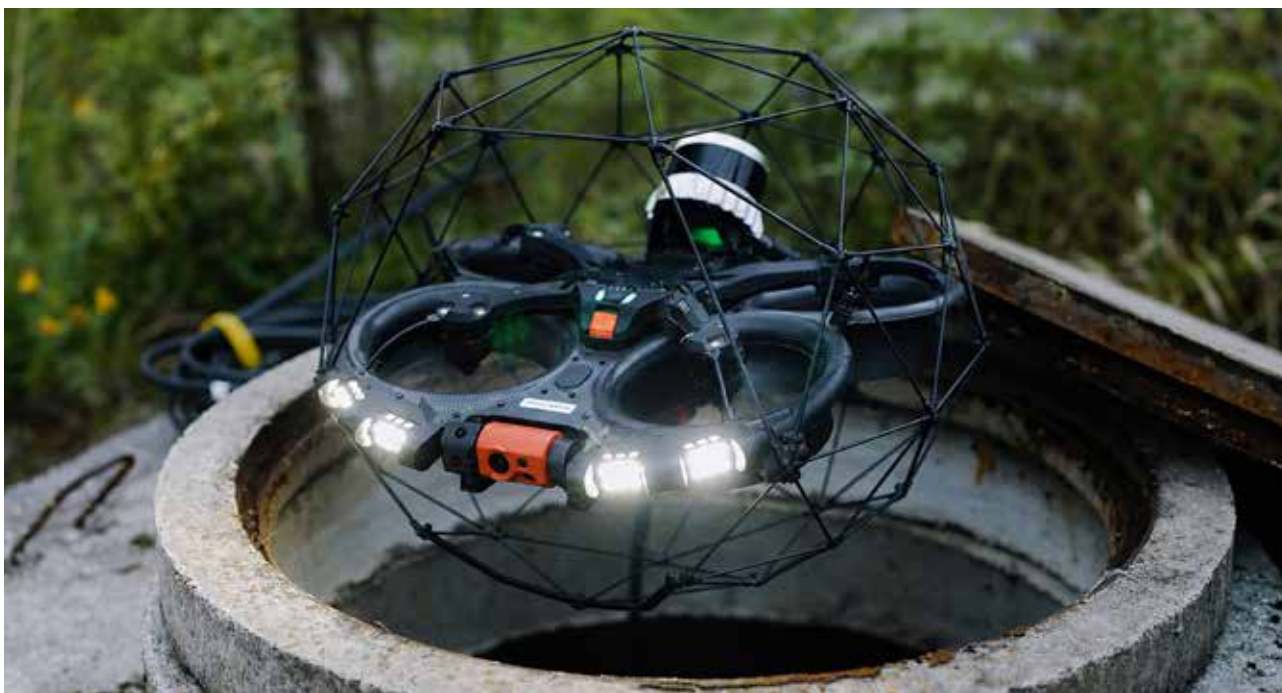
Obr. 1 – Bezpilotný systém pripravený na nasadenie do kanalizačného zberača
