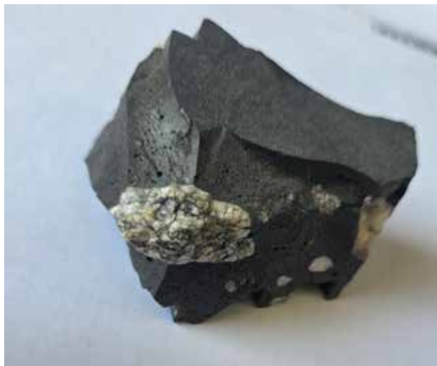
FOTOGRAFIE 7– střep prasklého žlabu
