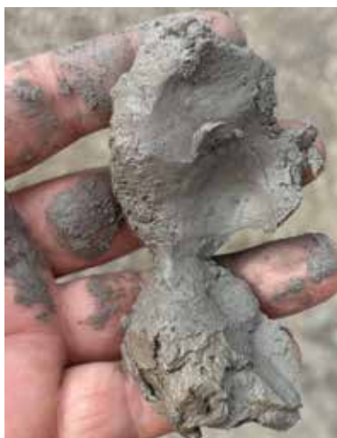
Obr. 2 – Vytěžený plastický jíl a předrcený křemenec drtičem stroje na konci separačního zařízení HKS150
