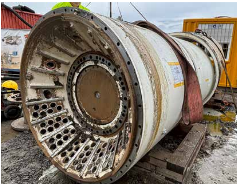
Obr. 5 – Přestavba stroje AVN1200 TC z DN 1400 na DN 1200 v podmínkách in-situ
