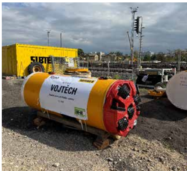
Obr. 3 - stroj typu Herrenknecht AVN800 HR (Hard Rock)
