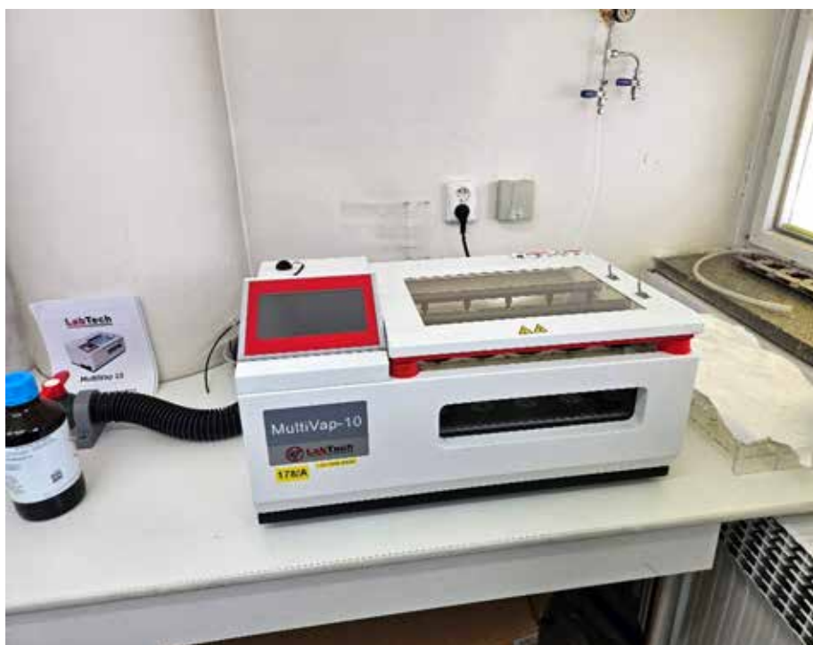
Obr. 4 Koncentrátor vzorků LabTech MultiVap-10 používaný při přípravě vzorků pro analýzu NIAS
