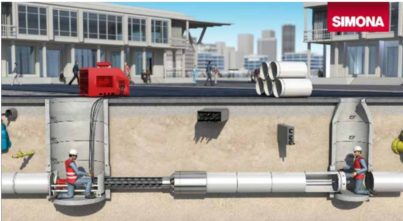
Obr.: Pilotní protlačování (PTM) s PP protlačovacími trubkami ze startovacích šachet DN 2000.
