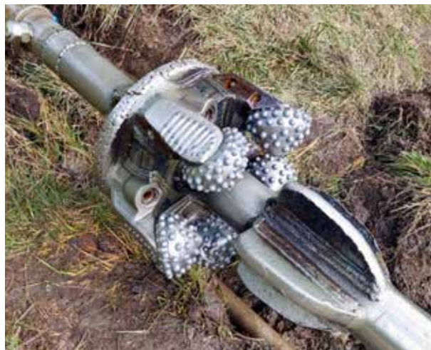
Obr. 11 Valivá dláta pro rozšíření vrtu po průchodu terénem (Zdroj: archiv TALPA-RPF)
