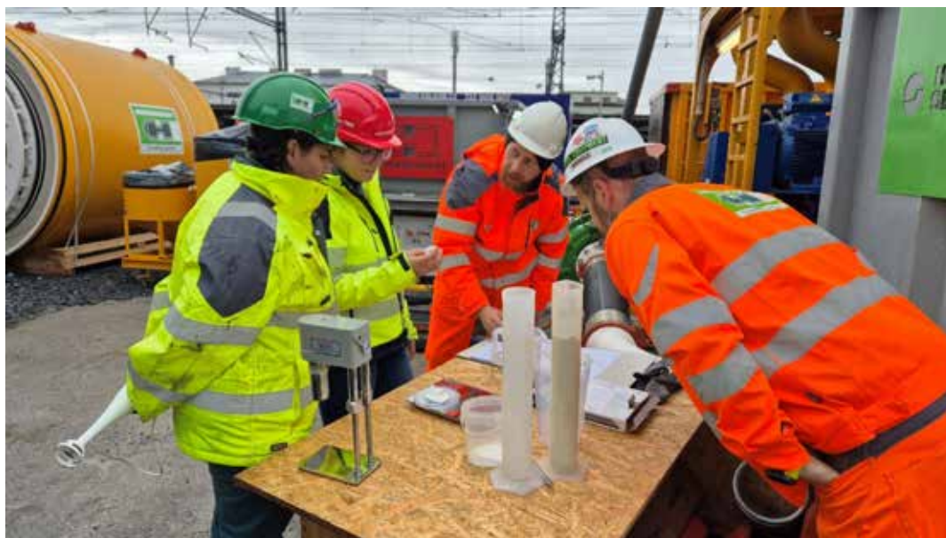
Obr. 6 Zkoušky bentonitové suspenze
