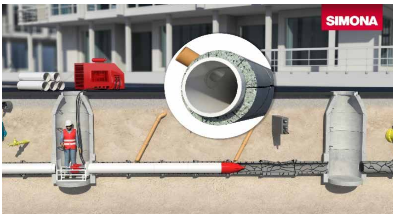
Obr. 6 Schéma metody TIP, od šachty k šachtě
