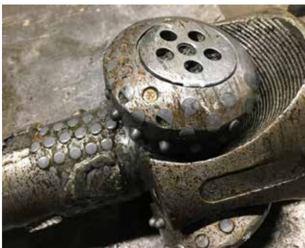
Obr. 12 Opatření valivých dlát po práci v náročných geologických podmínkách (Zdroj: archiv TALPA-RPF)
