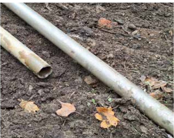
Obr. 13 Zlomené vrtné tyče (Zdroj: fotodokumentace zakázky TALPA-RPF s.r.o.)
