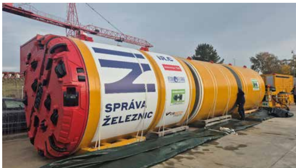
Obr. 4 Tunelovací stroj Herrenknecht AVN 2000 AH
