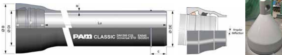
Obr. 6: Trubka DN 1100 mm se spojem UNIVERSAL Ve a tažná hlavice
