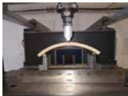
Ohybová zkouška, díky obloukovité geometrii modifikace ve výpočtu výsledků podle Přílohy B normy ČSN EN ISO 11298-4
