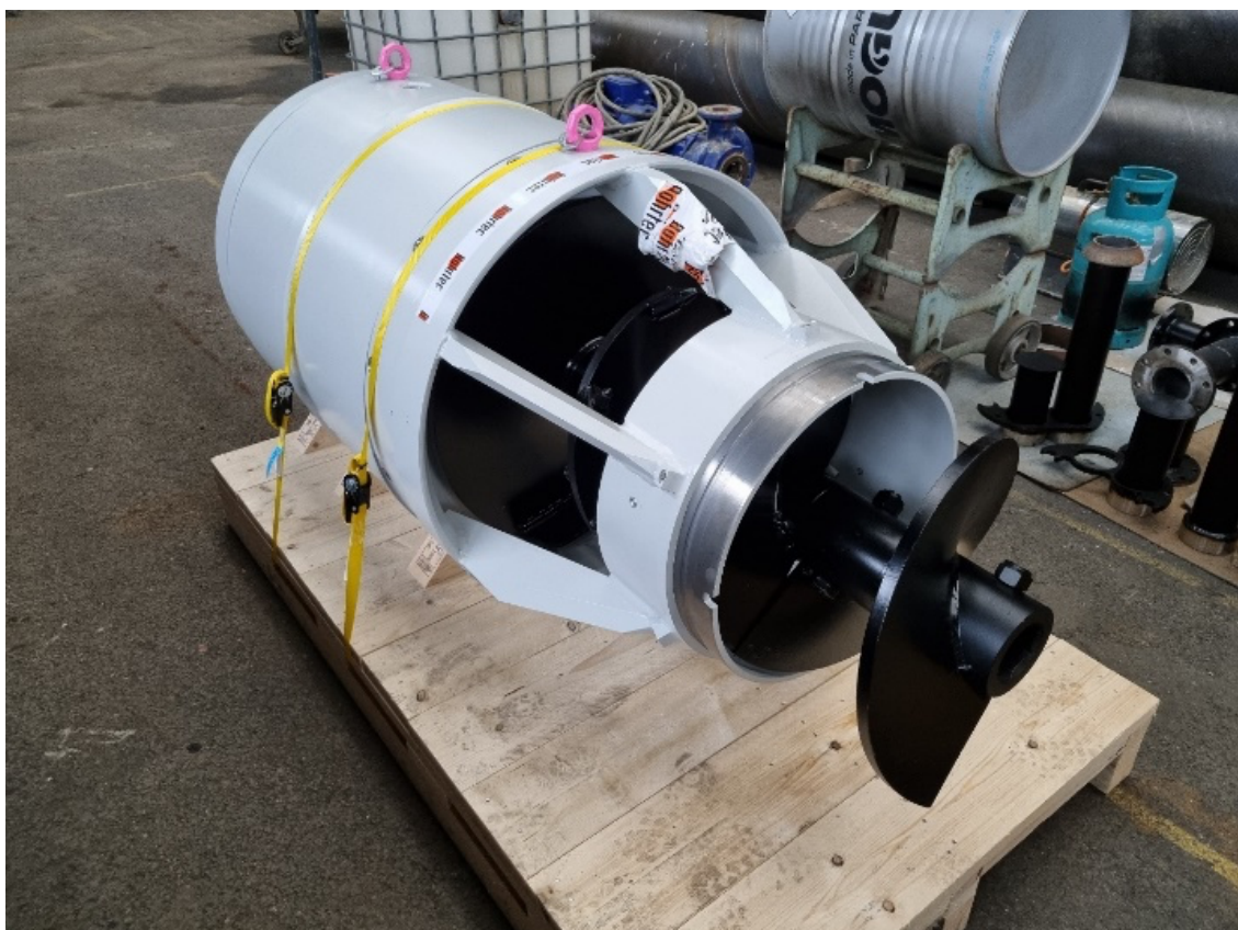
Obrázek 10 – Rozšíření na vrtnou soupravu Bohrtec BM500-S – hydraulický motor s rozšířením z OD 550 na OD 860 mm pořízený na akci I/33 Jaroměř-obchvat, s ohledem na změnu geologického prostředí však nebyl doposud nasazen
